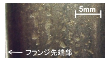
図 8 あばた状の車輪フランジ表面
