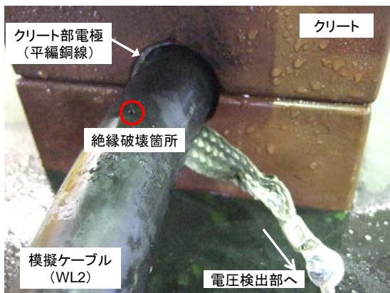
図 4 模擬地絡試験の状況
