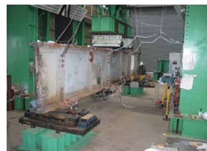
模擬桁を用いた疲労試験状況 図3 小型試験片と模擬桁の試験状況
