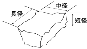
図1 落下岩塊の大きさの計測方法
