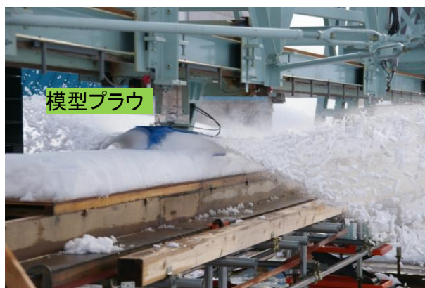
図3 試作したスノープラウの排雪試験
