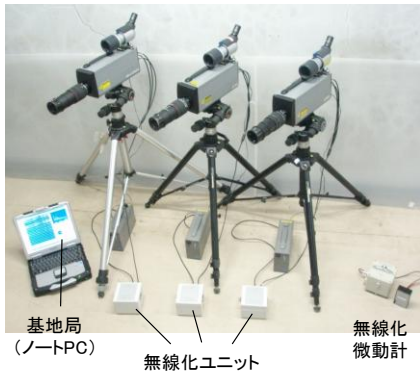
図 7 岩盤斜面計測システム
