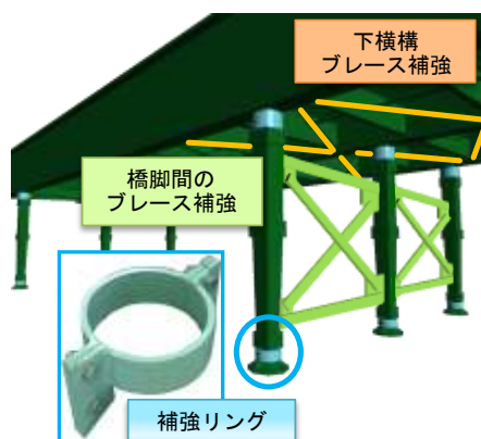
図10 旧式鋼構造物の各種補強法
