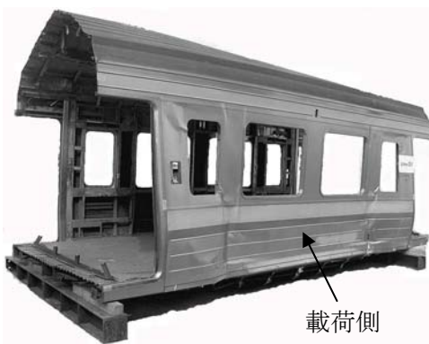
図3 変形形状（試験条件 M3）
