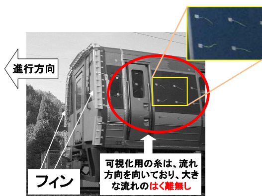
図4 在来線先頭車両の空気抵抗低減に関する試験
