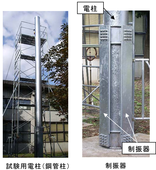
図5 実スケール電柱での実装加振試験
