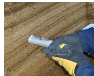
図 6 土壌硬度計による支持強度の計測状況
