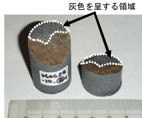
図8 直接引張試験時の破壊面の状況
