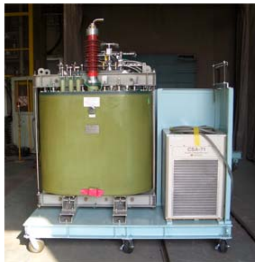
図 2 超電導主変圧器
