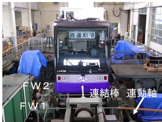
図 1 鉄道総研内車両試験台設備概要
