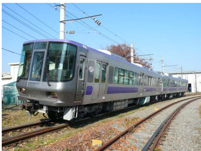
図1 燃料電池試験電車
