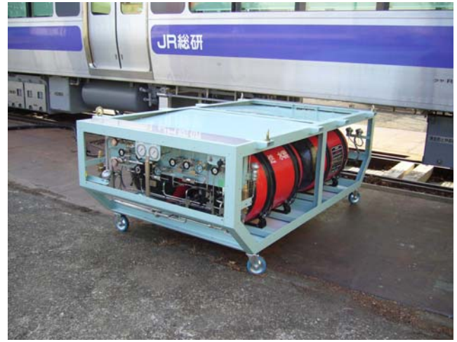
図 3 高圧水素タンクシステム
