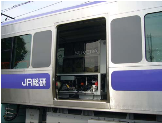
図 2 車両に搭載された 100kW 級燃料電池
