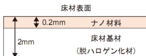
図8 ナノ材料を適用した床材の構成
