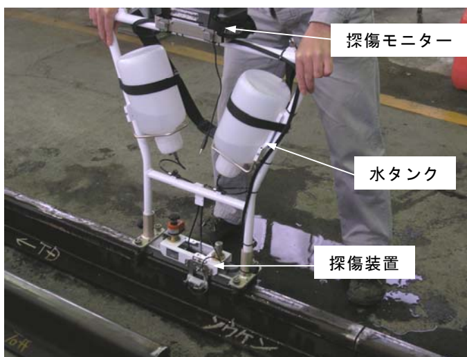
図5 透過法による連続探傷試験の実施状況
