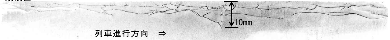
図 6 内部きずの発生状況（レール中心から GC 側へ 12.5mm 位置）
