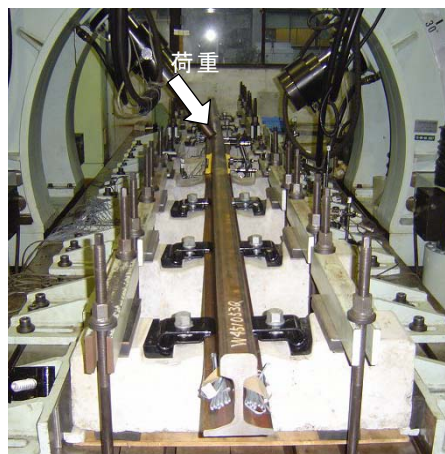
図 8 静的载荷試験の状況
