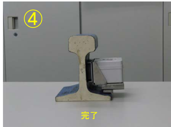
図8 無線センサユニットのレールへの取付手順
