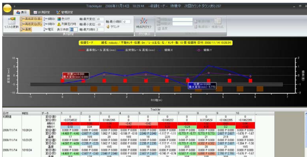
図7 軌道変位常時監視システムのインターフェース画面(開発中)
