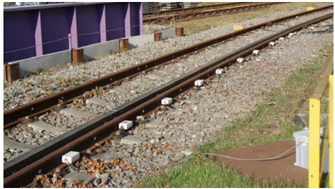
図4 無線センサネットワークを用いた軌道変位監視システム(試作機)
