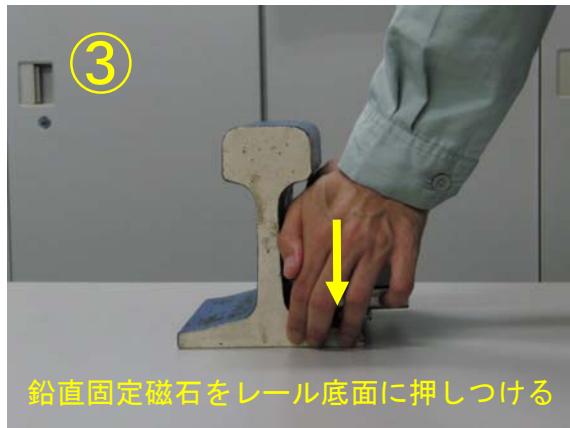
図8 無線センサユニットのレールへの取付手順
