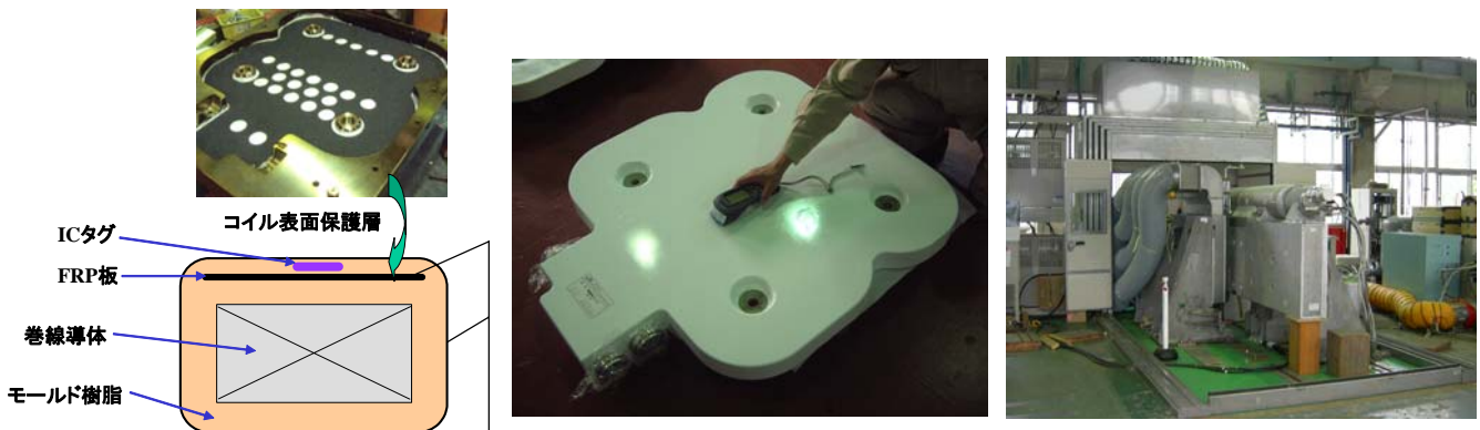
図 1 IC タグ設置箇所 図 2 IC タグ読み取り試験状況 図 3 IC タグ耐久性試験状況
