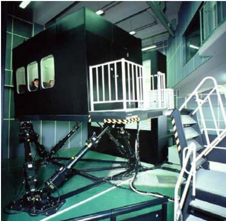
図3 実験室で客室内環境を模擬可能な車内快適性シミュレータ
