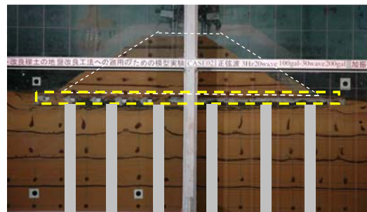
図4 セメント改良礫土による液状化対策効果に関する振動実験
