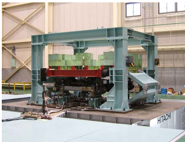
図8 台車の加振実験
