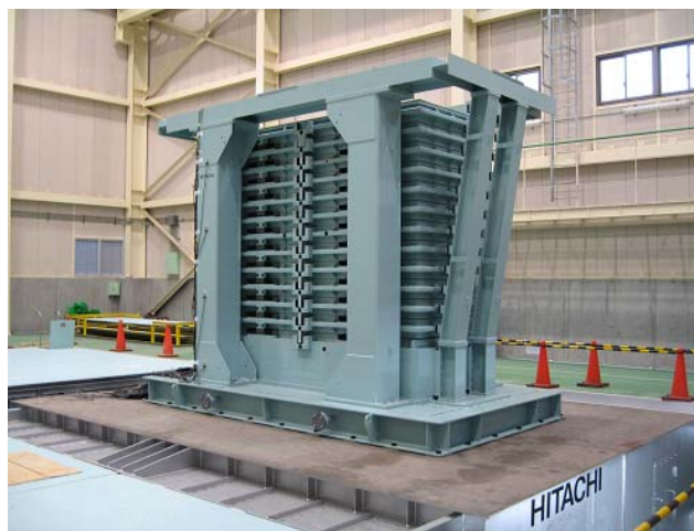
図9 セン断土槽を用いた加振実験
