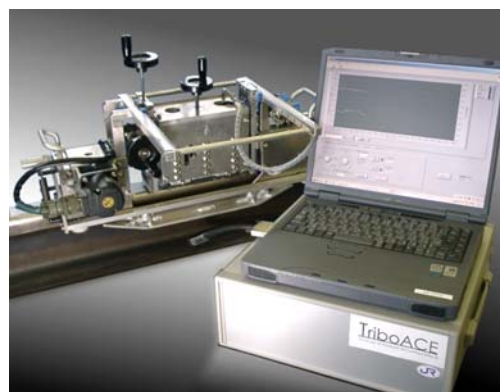
図5 レール表面摩擦係数測定評価システム(トライボエース)
