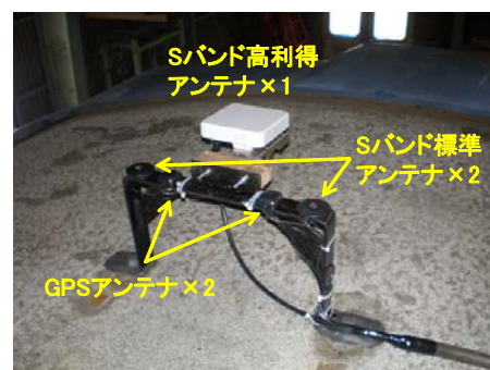
図7 車両の屋根へのアンテナ設置状況
