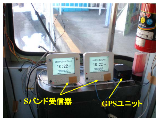
図8 車内での試験状況
