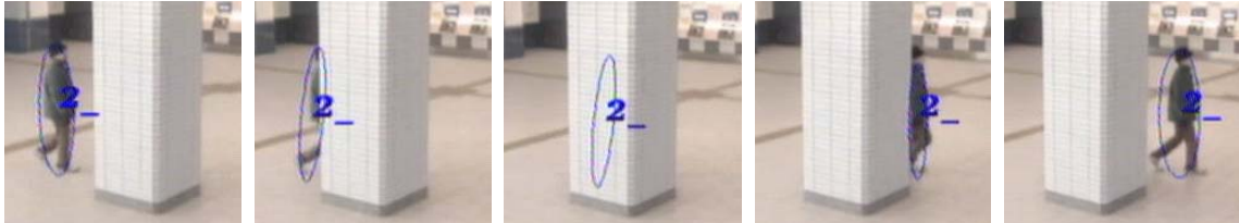
図5 カルマンフィルタによる隠れに頑強な追跡アルゴリズム
