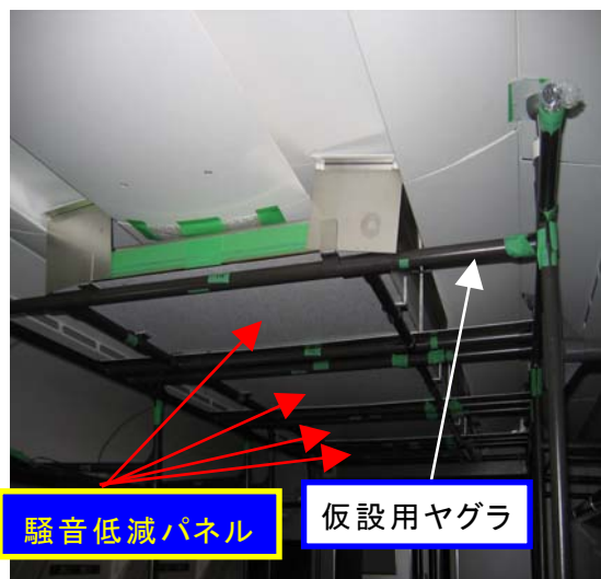
図6 パンタグラフ部騒音低減試験(明かり区間) 図7 パンタグラフ部騒音低減試験(明かり区間)
