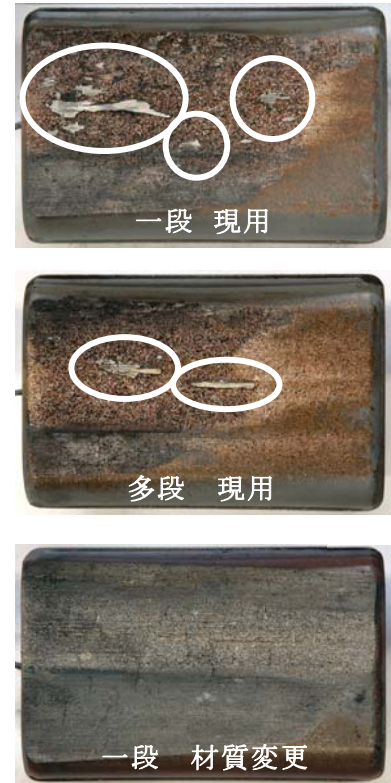
図6 発生したかじり鉄片 (湿潤、8号珪砂散布)
