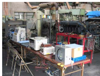
図3 ベンチ試験台の排ガス測定
