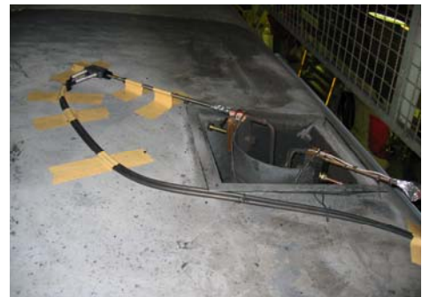
図 7 屋根上のプローブ取付状態
