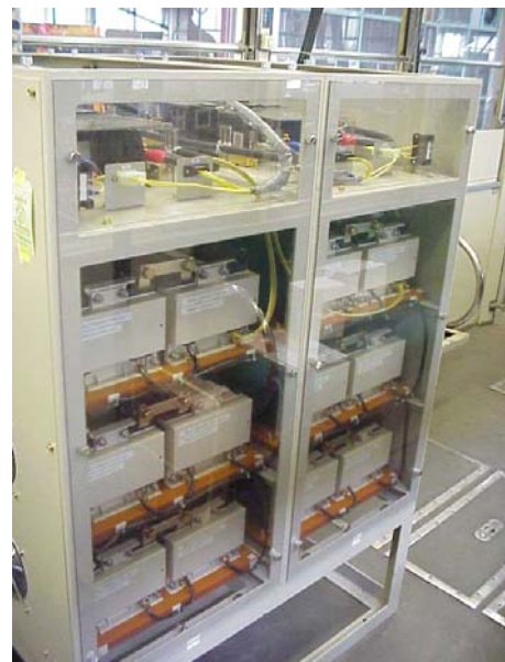
図5 開発したリチウムイオン二次電池
