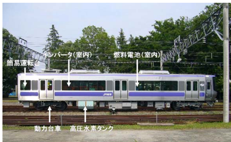
図9 燃料電池試験電車の構成
