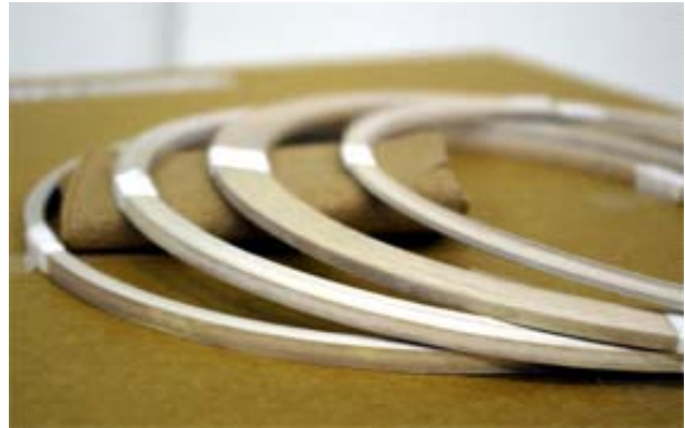
図7 開発した低損失超伝導線材
