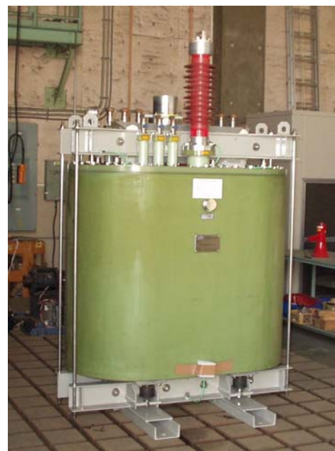
図2 試作した超電導主変圧器
