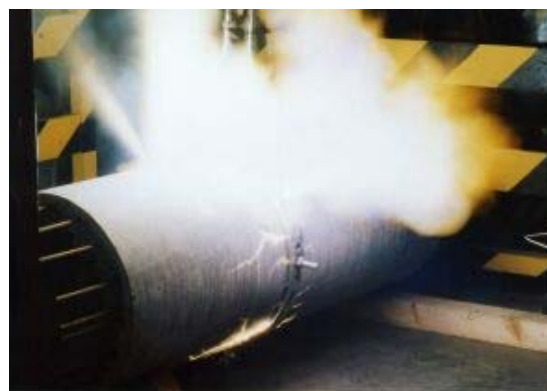
図5 コンクリート柱の絶縁破壊試験
