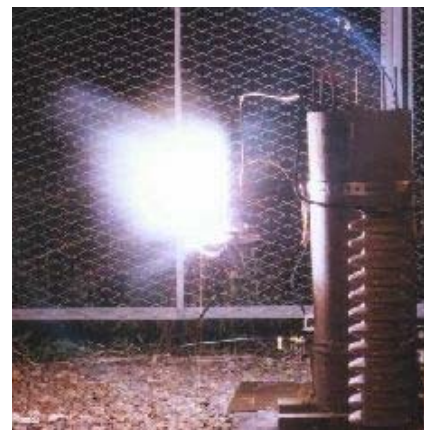
図11 人工地絡故障試験の様子
