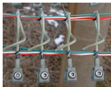
図10 新材質イヤを用いて製作したハンガイヤーの暴露試験状況
