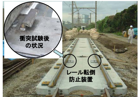
図8 レール転倒防止装置の衝突試験状況（JR東日本・東海道貨物支線の試験場）
