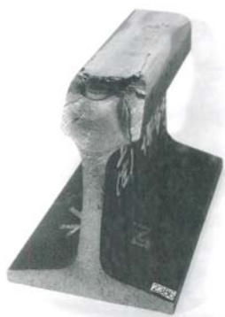
図2 レールシェリング破断面
