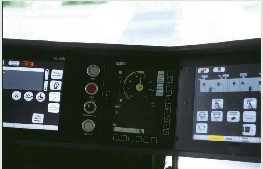
駅接近時に DMI (Driver-machine interfaces) に表示されるブレーキ曲線
