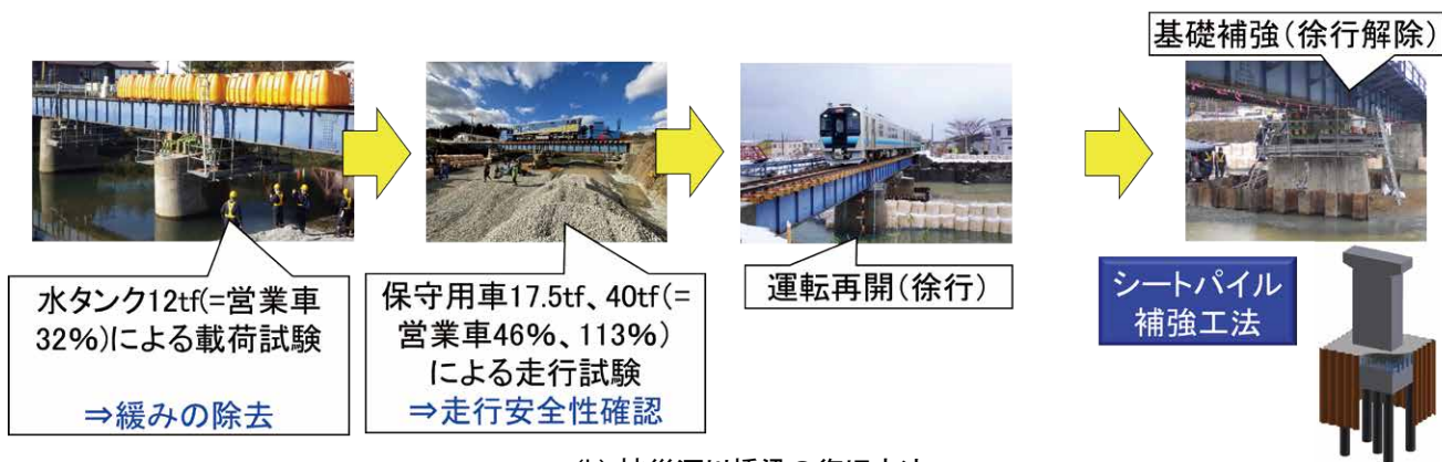
(b) 被災河川橋梁の復旧方法
