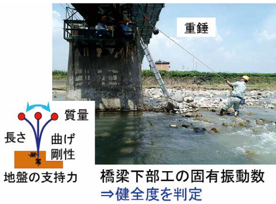
図5 衝撃振動試験
