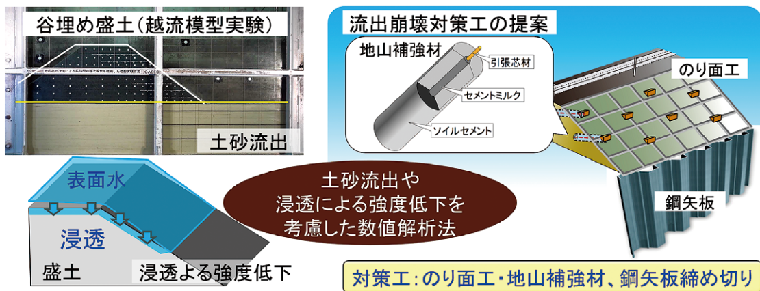
図 12 土砂流出、浸透による強度低下を考慮した河川沿いの盛土/谷埋め盛土の診断・補強技術
