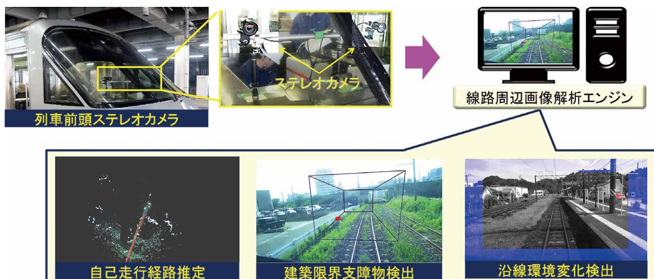
図2 線路周辺画像解析エンジン
