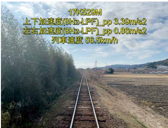
図7 車内に設置したスマートフォンにより取得した画像に車両動揺および速度・キロ程情報を重畳表示
