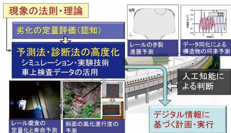
図 15 予測・診断の高度化とデジタル情報に基づくメンテナンスの向上
