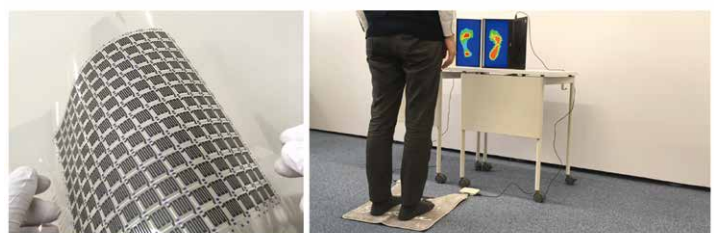
(b) フィルム素材に印刷可能な分布圧力センサ
