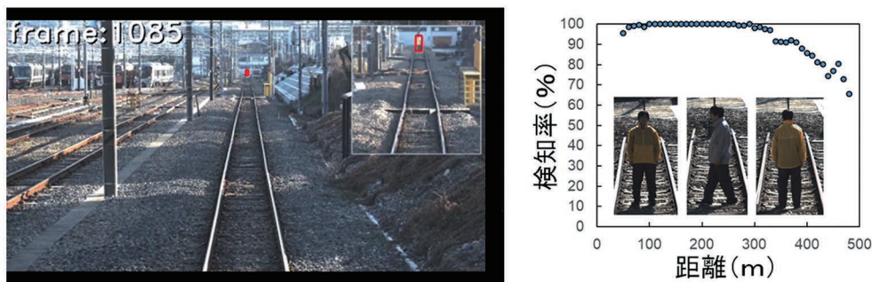
図5 ディープラーニングを用いた列車前方の人物検知手法による検知率の検証結果例(昼間・立位の場合)
