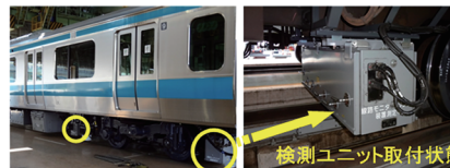
図4 慣性正矢軌道検測装置、軌道保守管理データベースシステムLABOCS
