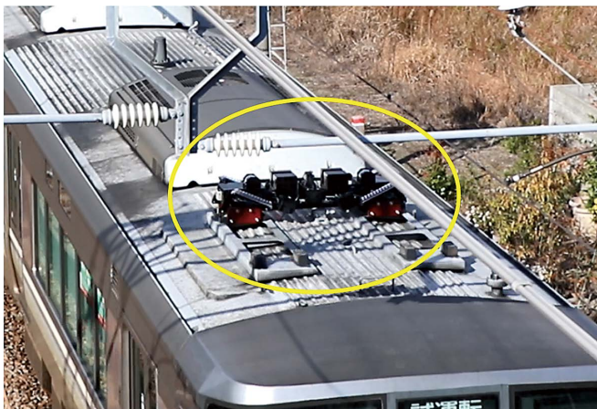
図 12 電車線非接触測定装置
