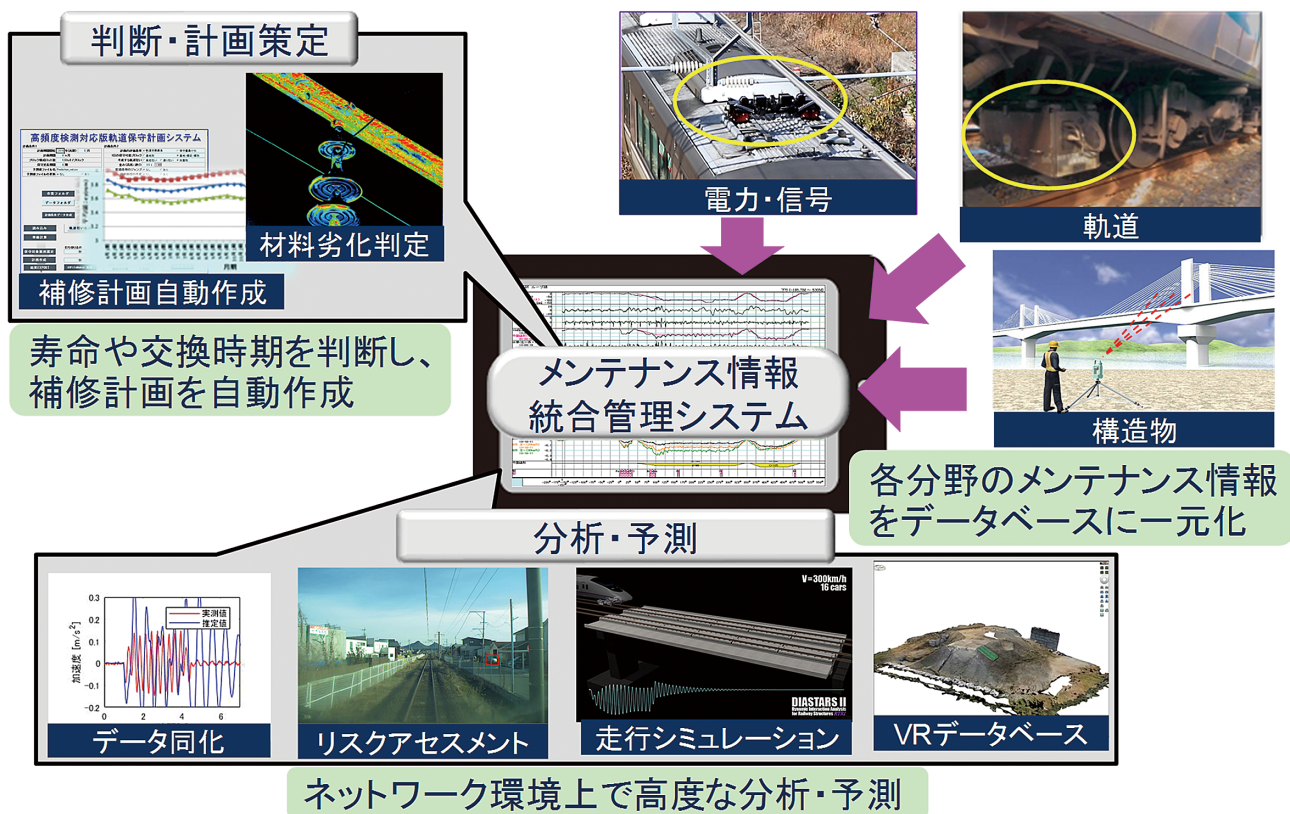
図21 ICTを活用したメンテナンス情報の統合管理のイメージ
