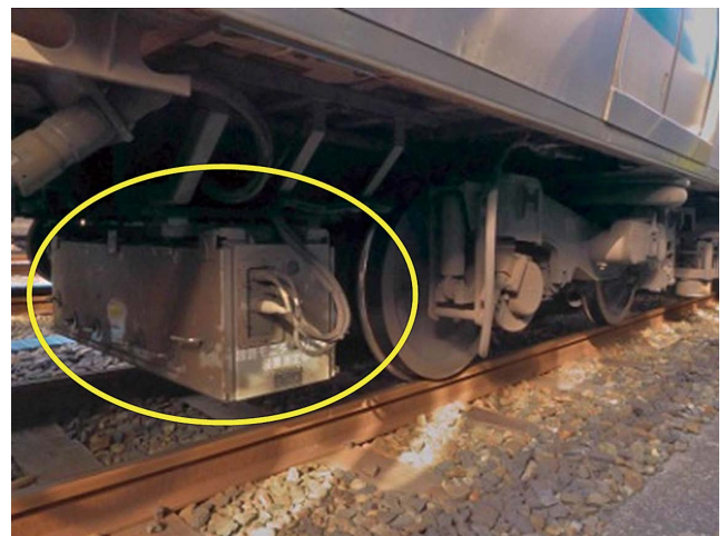
図17 営業車に搭載された慣性正矢軌道検測装置
