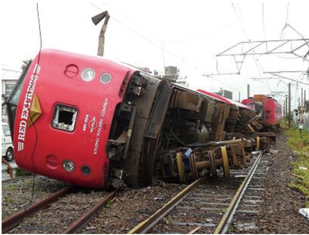
図4 突風による列車の転覆例(2006年, 日豊本線: JR九州提供)
