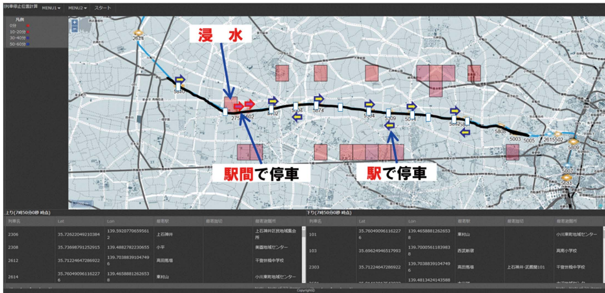
図7 リアルタイムハザードマップによる運転規制・避難誘導支援システム例
