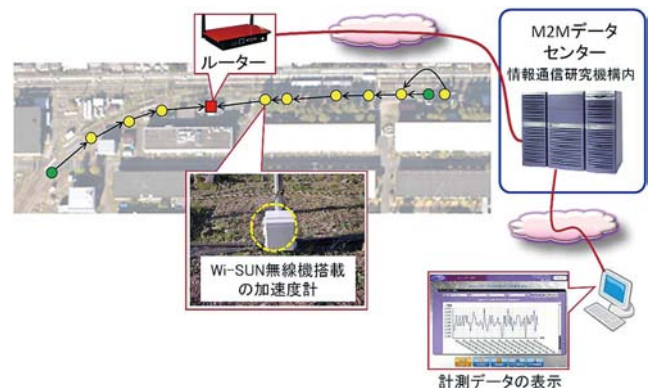
図11 無線センサーネットワークの所内試験
