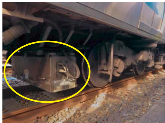
図8 慣性正矢軌道検測装置(車体装架型)
