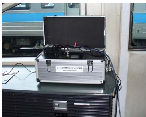
図14 レール波状摩耗モニタリング装置
