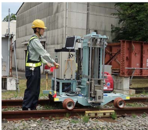
図16 軌道支持剛性評価装置(トロリータイプ試作機)
