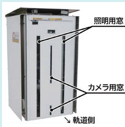
図2 車両外観撮影装置
