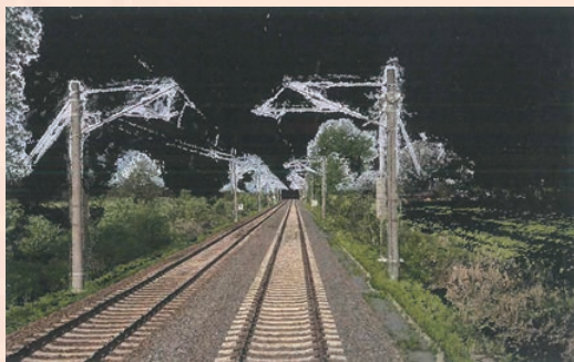
通常走行時の動画による写真測量点群 (出典: A.Wolf/Bahnkonzept ドレスデン) 《出典 Der Eisenbahningenieur》
