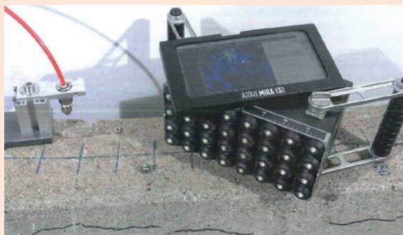
左から：圧縮空気ノズルを使用した空気結合型衝撃エコー励起部、手動励起用インパクトハンマー、超音波アレイ（出典：BAM） 《出典 Der Eisenbahningenieur》
