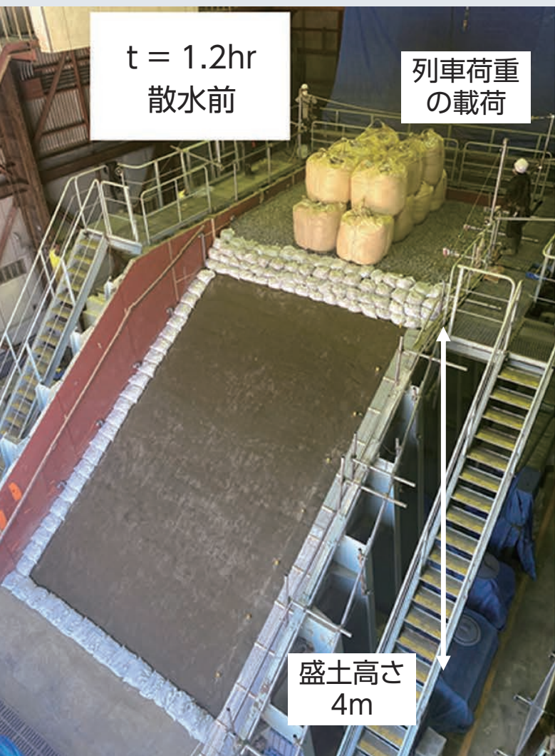
図3 実規模盛土の降雨散水による崩壊・载荷試験
