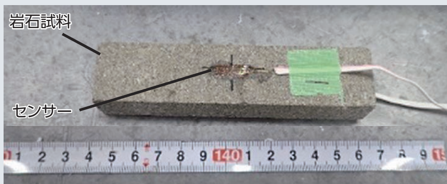
図3 ひずみ測定用のセンサーを貼り付けた岩石試料
